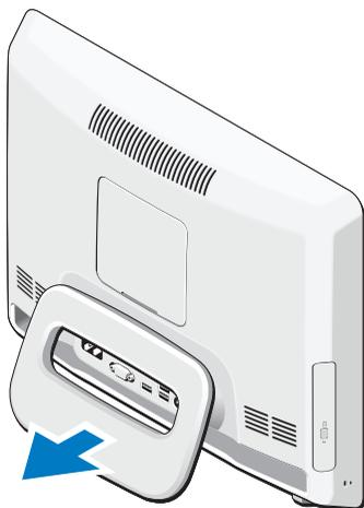
Vostro 320 también admite montajes de pared VESA con certificado UL (sólo 100 mm x 100 mm). Para un montaje correcto, utilice cuatro tornillos de 4 mm de diámetro, 0,7 mm de paso y 10 mm de largo cada uno (en placas con 2,6 mm de grosor).
